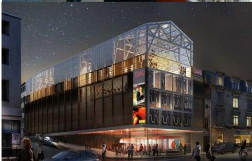
Le bâtiment est réalisé à partir d'une structure primaire en béton pour les 3 niveaux. Elle est recouverte d'une charpente traditionnelle habillée de polycarbonate créant ainsi une double couverture en plus de l'étanchéité qui couvre l'édifice.
